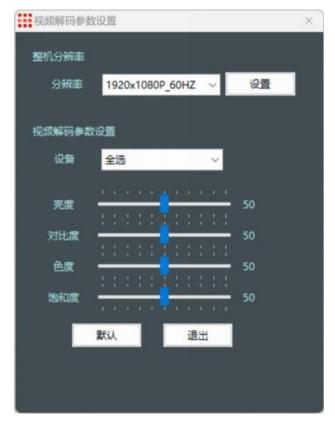
电脑端操作:修改解码器HDMI输出参数
