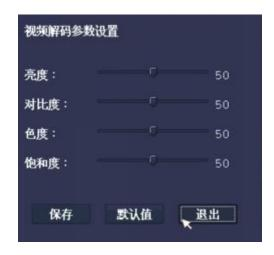
鼠标操作:修改解码器HDMI输出参数
